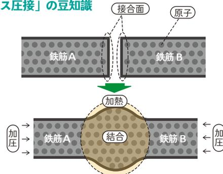
金属の結合は金属原子の電子が原子間で共有化されて結合しています。そのため切り離されている金属は、互いの原子間の距離が原子レベルまで接近すると結合します。ガス圧接では加熱と加圧の塑性変形で接合面間を近づけて接合させます。
